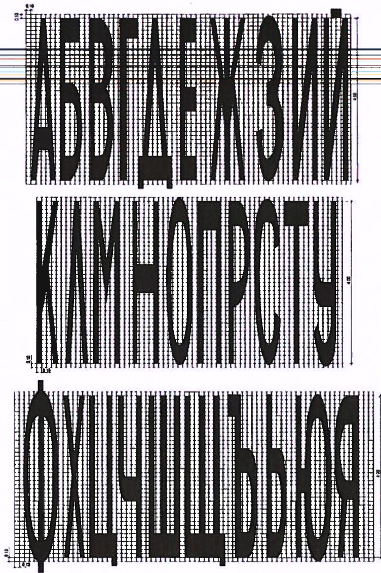
Размери на буквите при допустима максимална скорост на движение V > 50 km/h.
