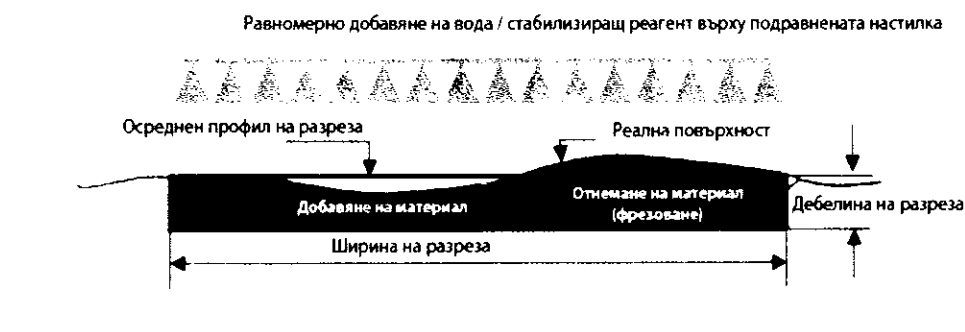
Фиг.1.9 Променливи количества на нанасяне поради лоша форма на повърхността
