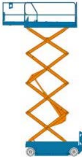
Фиг.11: Ножична повдигателна платформа
