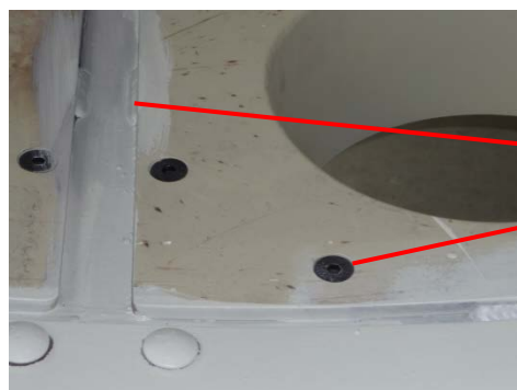
Фиг. 29: Винтови съединения, които трябва да се развият
