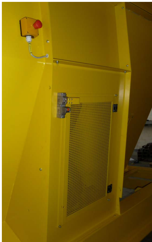
Обезопасяване на клапата за поддръжка към работните колела
