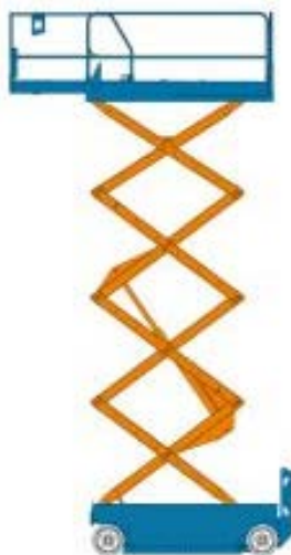
Фиг. 11: Ножична повдигателна платформа
