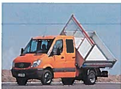
Примерна снимка – спец. автомобил, 2 оси, оловина кабина и 8м 3 каросерия
