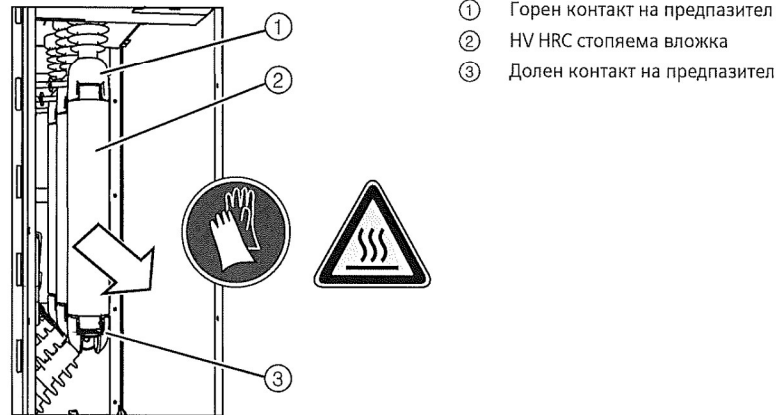
Фиг. 99: Общ вид на отстраняване на HV HRC стопяема вложка (изглед от страни)
